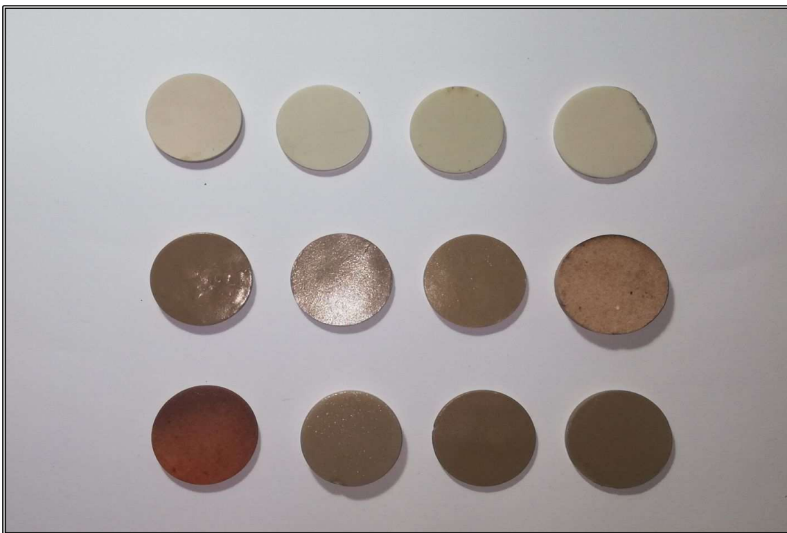
Foto n°5 - Provini dei sottoprodotti, dello sterile presente nei cantieri estrattivi e del sottovaglio dopo la prima frantumazione e vagliatura in impianto, a confronto con quelli del minerale mercantile.
